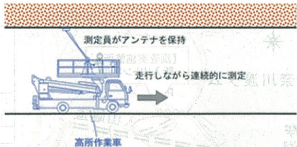
図3 地中レーダー探査測定状況の模式図
