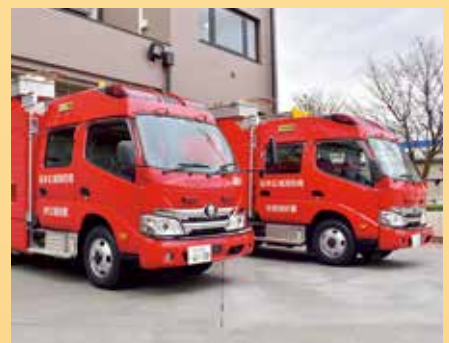
消防ポンプ自動車(水槽付)
