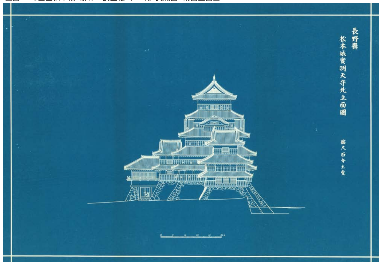
図面 11 『国宝松本城 解体・調査編 (S29)』実測図 北面立面図
