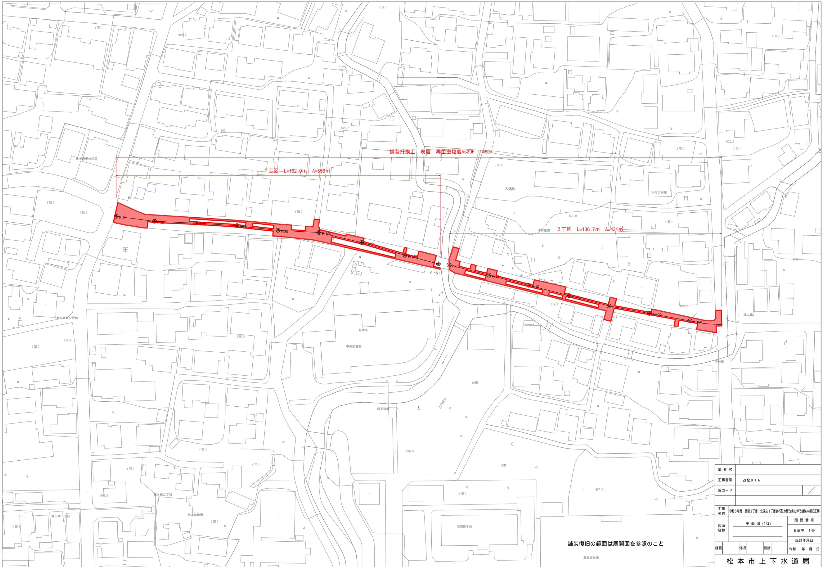
舗装打換工 表層 再生密粒度As20F T=5cm
