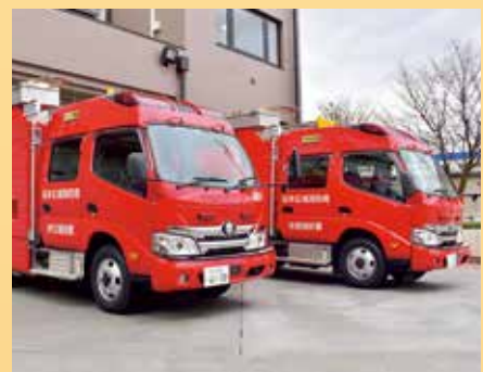
消防ポンプ自動車(水槽付)
