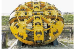
353m掘り進んだシールドマシン(掘削機)最前部
