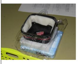
②放射線観察装置(霧箱)です。 装置の下にドライアイスを置い て、装置内を冷やしています。中 にあるのは、ランタンに使うマントルです。マントルから出る放射 線の軌跡を観察します。放射線は 目には見えませんが、放射線が飛 んだ跡に、飛行機雲のような白い 筋が残るので、それを観察しま す。
