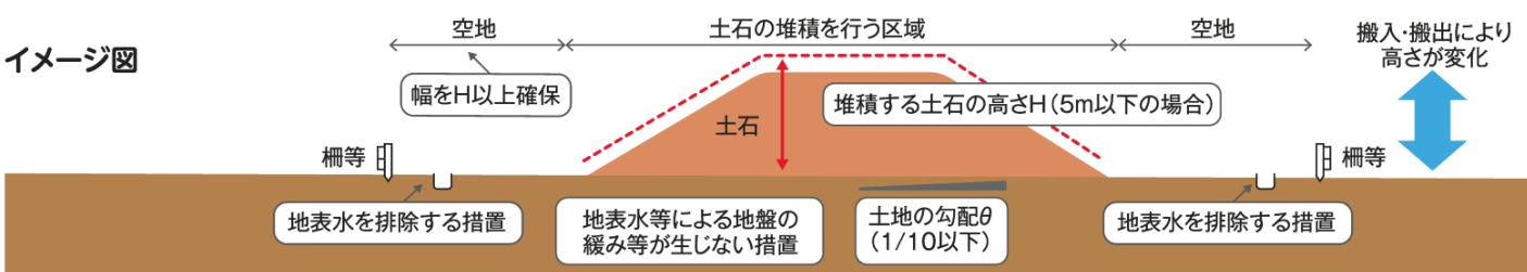
\*堆積する土石の高さが5m超の場合、当該高さの2倍を超える幅の空地が必要です。 \*上記は技術的基準を満たす堆積方法の一例であり、施設を設置すること等により空地の確保が不要となる場合もあります。
