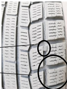
劣化したタイヤ
